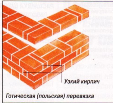
Рис. Ж. В этом случае каждый тычковый кирпич располагается между двумя ложковыми того же ряда и в средней части ложковых верхнего и нижнего рядов. Эта кладка характеризуется ещё и различной окраской кирпичей, обожжённых разными способами.
