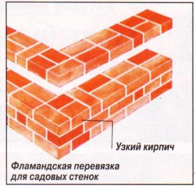
Рис. И. Здесь показан модифицированный вариант фламандской перевязки. Он характерен тем, что около каждого третьего ложка данного ряда расположен тычок, находящийся посередине ложка нижнего ряда.
